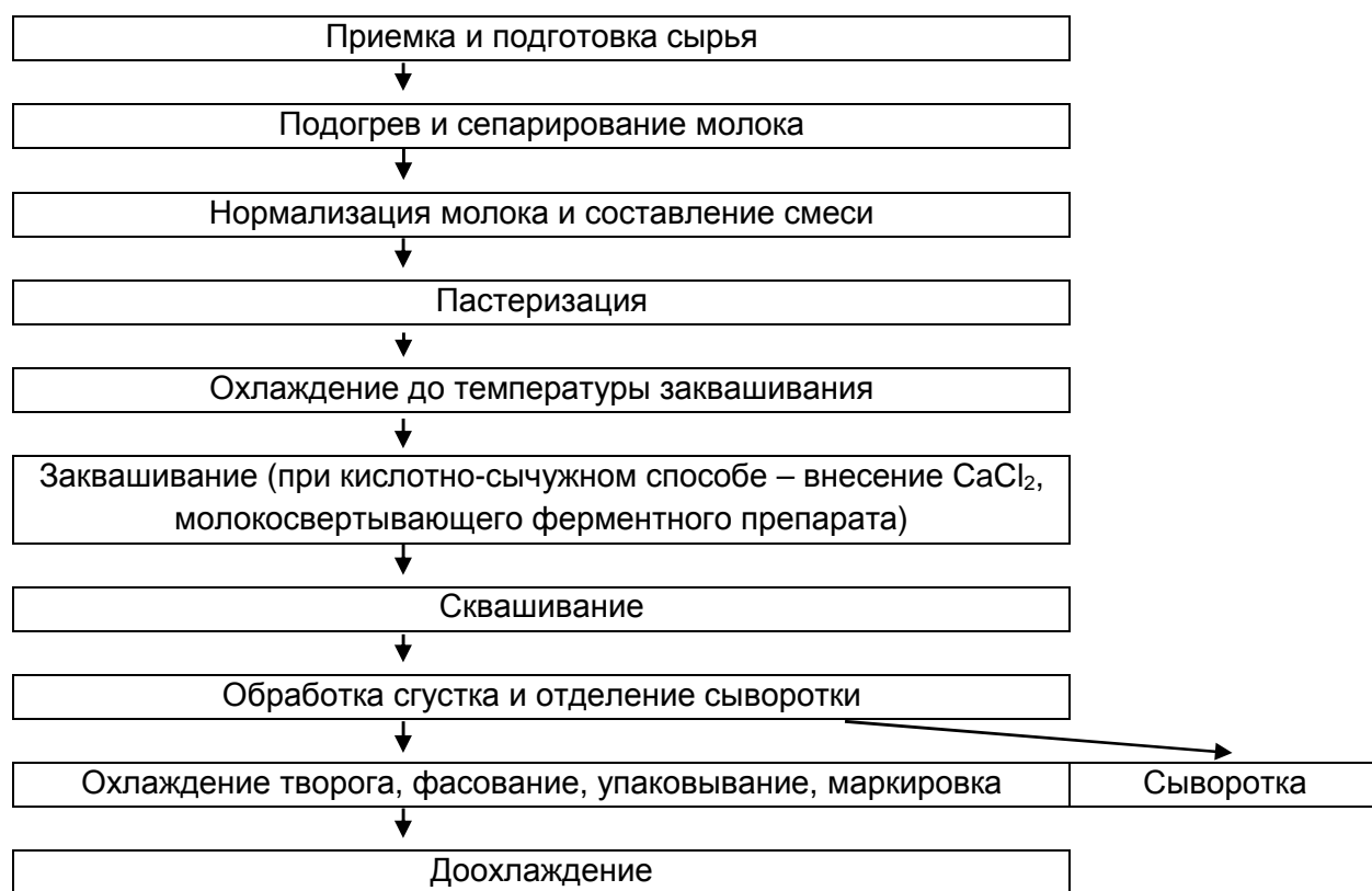
Рисунок 2.9 – Технологическая схема производства творога
